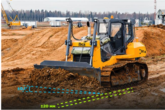
01. Внедрение помощников оператора Система нивелирования, автозвешивание, интеллектуальное слежение за слепыми зонами и т.д.
