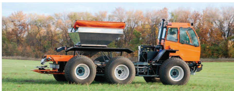
Bei der Tuman-Serie können auf demselben Fahrgestell, Spritze, Gebläse, Multiinjektoren oder wie auf dem Bild Düngerstreuer montiert sein.
